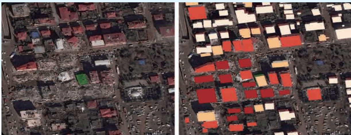
그림 7. Damage assessment using semantic segmentation (출처 : technologyreview.com)
